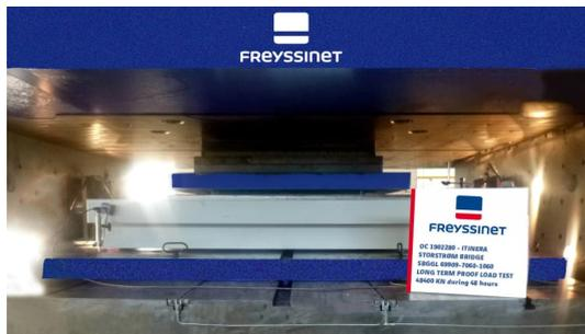
*Prova a compressione di lunga durata di un appoggio TETRON® SB eseguita nel nostro laboratorio ISOLAB (pressa 70MN)
