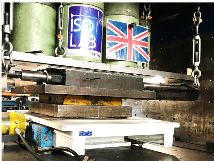
*Prova combinata di carico verticale e orizzontale su appoggio guidato TETRON® SB eseguita nel nostro laboratorio ISOLAB (pressa 50 MN)
