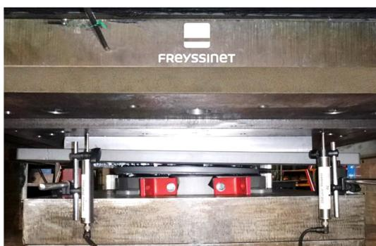
*Prova combinata di carico verticale & rotazione su appoggio TETRON® SB presso il nostro laboratorio ISOLAB (pressa 50MN)
