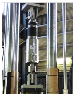
ISOSISM® STU in fase di prova
