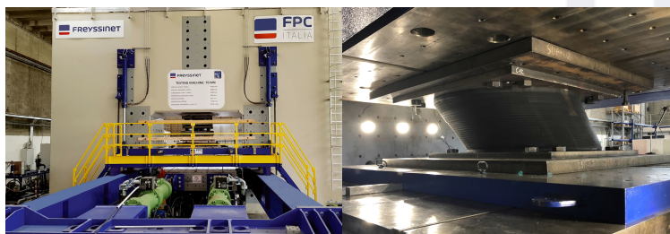
ISOSISM® LRB in fase di prova presso il laboratorio ISOLAB
